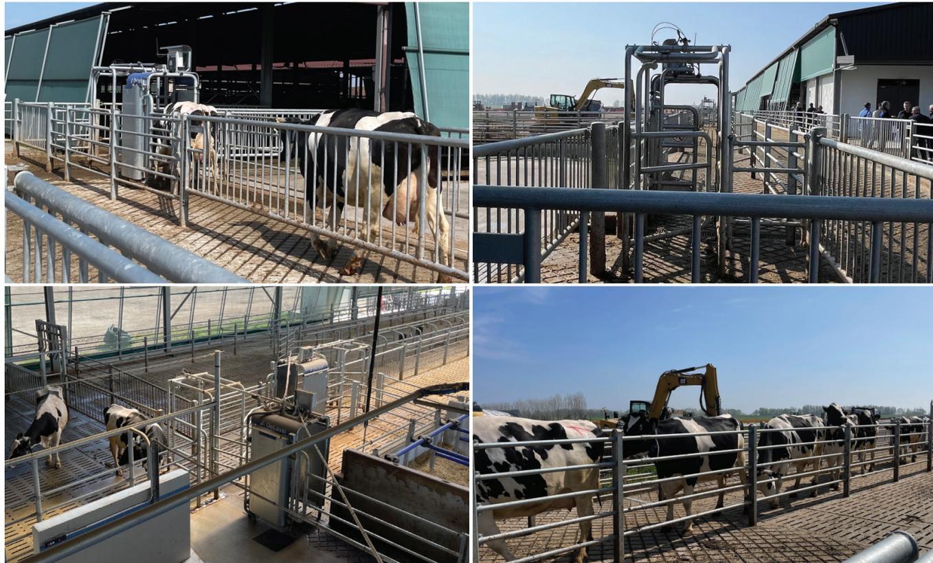
Tutti i movimenti delle bovine sono gestiti da cancelli separatori che indirizzano gli animali in maniera automatica in funzione dei dati impostati sul gestionale, ma anche secondo le informazioni ricevute dai robot in fase di mungitura.
